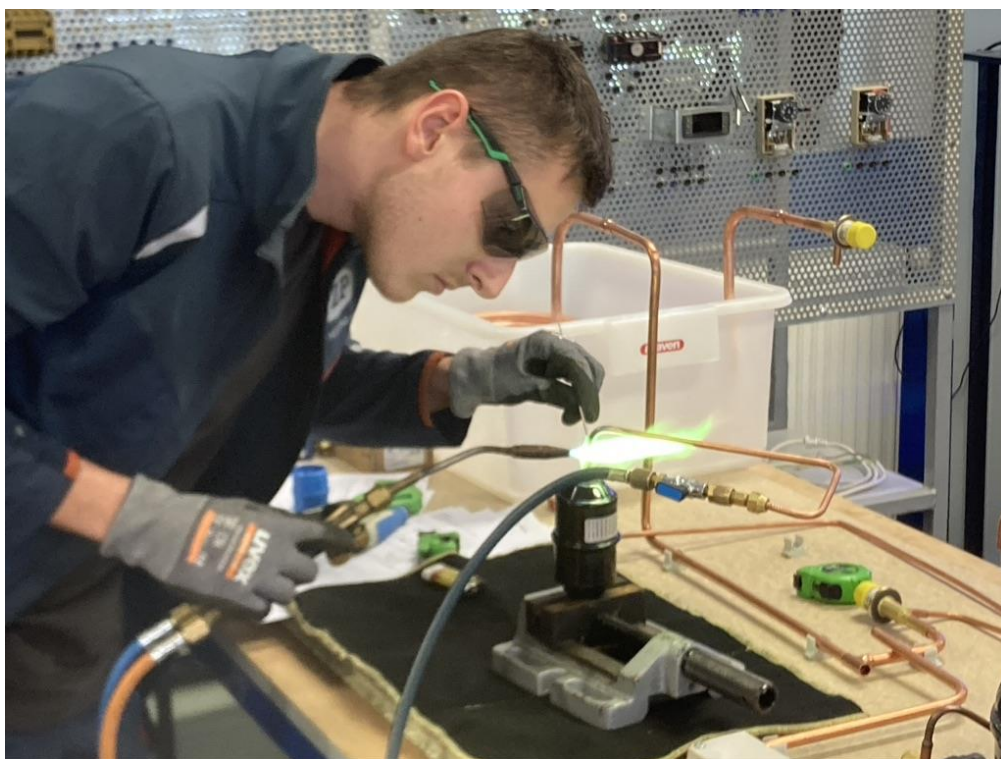
Obr. 4: Veškeré spoje byly pájené. Při všech rizikových činnostech byly vyžadovány prostředky osobní ochrany a za nedodržení se strhávaly body.
