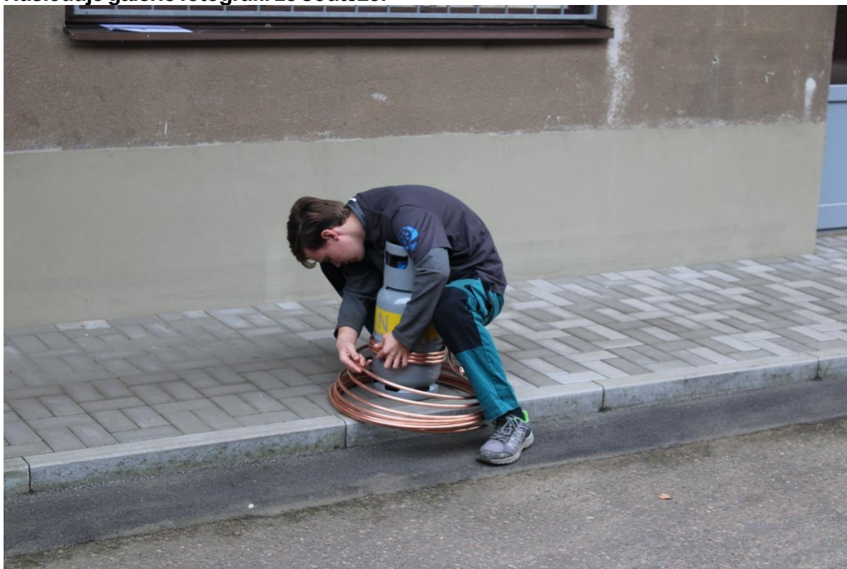
Obr. 1: Výroba závitového výparníku z Cu trubky obtočením kolem tlakové nádoby (pro nedostatek místa se pracovalo před dílnami)
